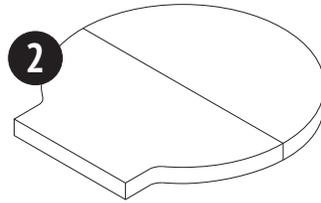
Depois da base de alvenaria pronta e seca, assentar a base do Forno para Pizza utilizando areia fina bem seca, deixando-a nivelada. Em seguida, rejuntar essa base.
