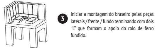
**3** Iniciar a montagem do braseiro pelas peças laterais / frente / fundo terminando com dois "L" que formam o apoio do ralo de ferro fundido.
