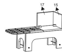
**2** Iniciar a montagem da caixa do forno de ferro fundido pelas peças 15 e 17.
