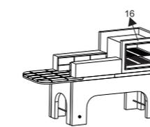
**3** Colocar o forno já com o aro (16). Em seguida, apoiar as laterais de apoio da chapa.
