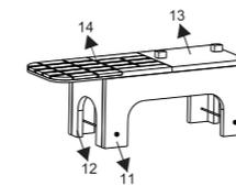
**1** Montar as 4 peças (11 e 12) que formam os pés (lado liso para fora), fixando com 2 parafusos. Em seguida coloca as peças que formam a base (13/14a/14).
