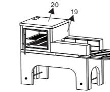
**4** Encaixar o forno ferro fundido fechando a caixa com as peças (19 e 20).
