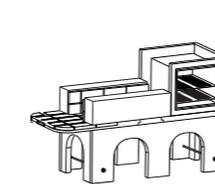
**4** Encaixar o forno ferro fundido fechando a caixa com as peças (19 e 20).
