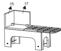
**2** Iniciar a montagem da caixa do forno de ferro fundido pelas peças 15 e 17.
